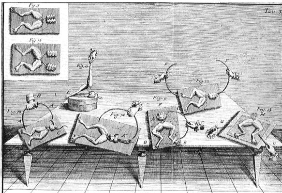
Ipotizza che il muscolo della rana sia un serbatoio dell' elettricità che fluisce attraverso i nervi, un condensatore, e che funzioni come una bottiglia di Leyda, che si scarica al contatto tra armatura interna (i nervi ne costituiscono l'elettrodo) ed esterna (superficie dei muscoli).
